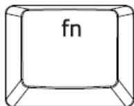
При нажатии и удерживании клавиши fn загораются все функциональные клавиши с второстепенными функциями, а также другие клавиши, которые можно нажимать в сочетании с клавишей fn. При нажатии клавиши fn в сочетании с функциональными клавишами будут активированы второстепенные функции вашего компьютера.
