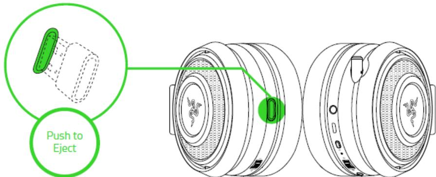
*Примечание. Чтобы установить беспроводной USB-приемопередатчик на место, вставьте его в гнездо и нажмите на него так, чтобы прозвучал щелчок.*
