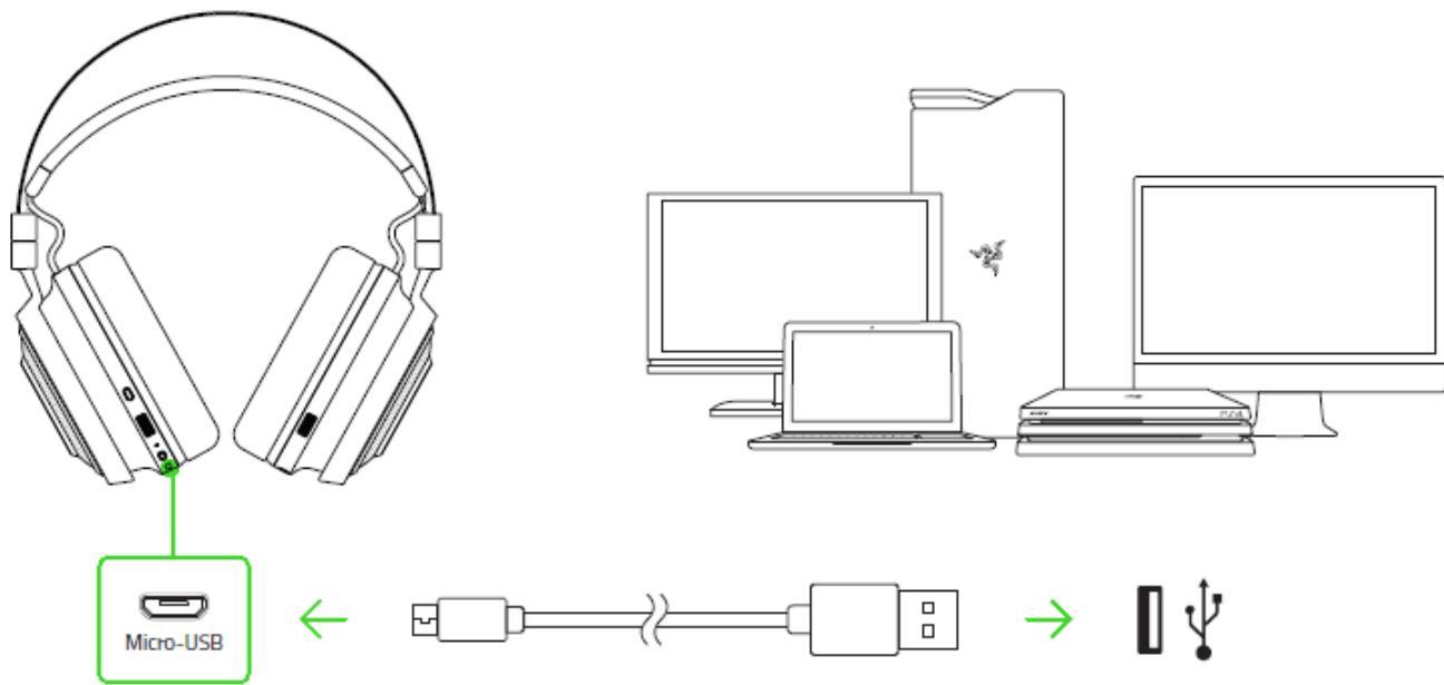
Для наилучшего результата полностью зарядите гарнитуру, прежде чем использовать ее в первый раз. Зарядка полностью разряженного аккумулятора длится приблизительно **4 часа**.
