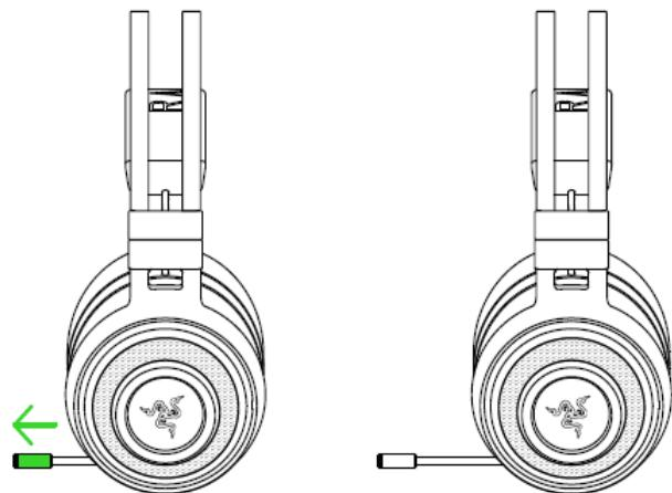
Согните микрофон так, чтобы он располагался параллельно вашему рту, а затем отрегулируйте его длину по своему предпочтению. Проверьте, чтобы диафрагма микрофона располагалась перед вашим ртом, а вентиляционные отверстия — со стороны, противоположной вашему рту.
